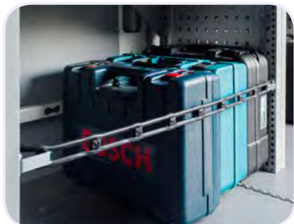
Het uittrekbare rubberen zgn. "ladderband" in combinatie met beugels aan beide zijden
